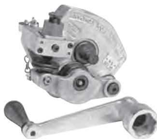
Pratica e leggera scanalatrice per la scanalatura manuale di tubazioni in acciaio Schedule 5, 10 e 40, in acciaio inox e in PVC. Con il sistema brevettato di rotazione bidirezionale della macchina sul tubo si consente la scanalatura riducendo gli scarti.
