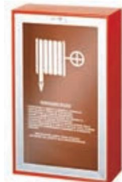
Completa di: rubinetto idrante DN 45 PN 16-ISO 7, tubazione Ø 45 mm certificata UNI EN 14540 raccordata UNI 804 con legatura a norma UNI 7422 con manicotti coprilegatura, sella salvamanichetta, simbolo di identificazione, istruzioni d'uso, istruzioni di montaggio, sigillo numerato, lancia a leva o a rotazione UNI 45, adesivo marcatura **CE**
