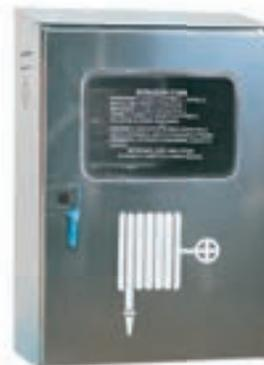
Completa di: rubinetto idrante DN 45 PN 16-ISO 7, tubazione Ø 45 mm certificata UNI EN 14540 raccordata UNI 804 con legatura a norma UNI 7422 con manicotti coprilegatura, sella salvamanichetta, simbolo di identificazione, istruzioni d'uso, istruzioni di montaggio, sigillo numerato, lancia a leva o a rotazione UNI 45, adesivo marcatura **CE**
