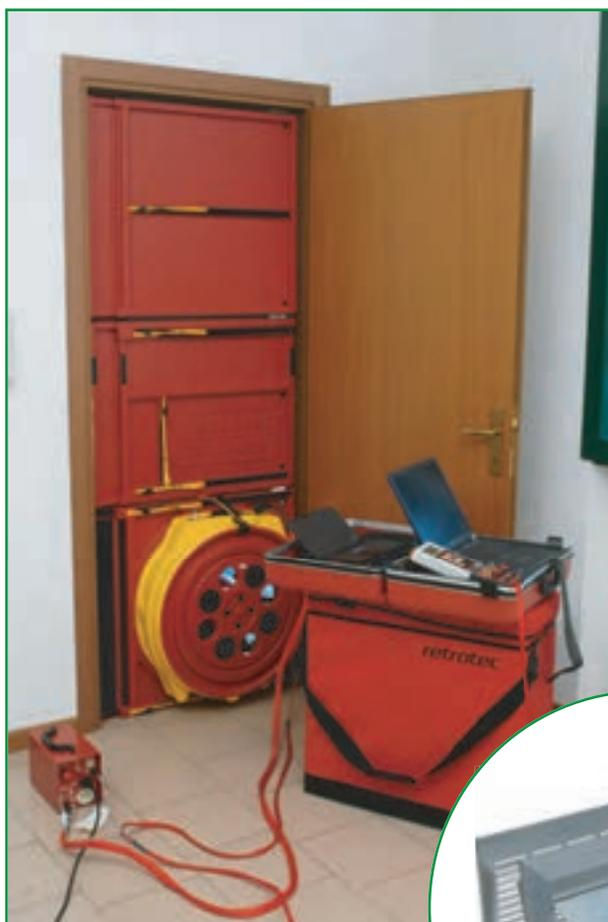
Il **Door Fan Integrity Test** è una prova che viene effettuata per verificare e certificare che, la concentrazione di spegnimento all'interno del locale da proteggere, venga mantenuta per almeno 10 minuti. Questo test è previsto obbligatoriamente dalla UNI EN 15004, sia in fase di installazione di nuovo impianto, sia in fase di manutenzione, quando non si ha la certezza che non siano stati effettuati attraversamenti murari o altri cambiamenti al volume protetto.
