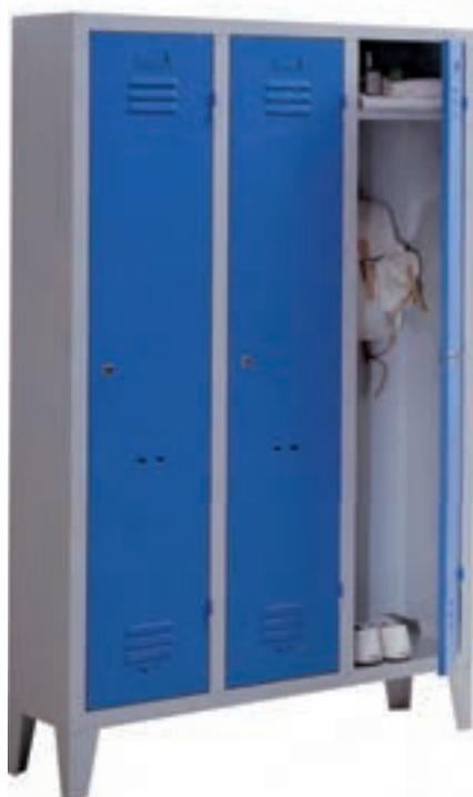
Costruiti con lamiera lucide di acciaio DC01, di 1° qualità, saldate elettricamente in modo da conferire al manufatto un'ottima stabilità. Internamente, ogni posto, è completo di un ripiano posa cappello con sottostante portamantello con gancio. Le ante, girevoli di 180° su robuste cerniere esterne, sono complete di porta cartellino stampato, doppia serie di feritoie per l'aerazione, chiusura con serratura metallica con chiave in duplice esemplare.
