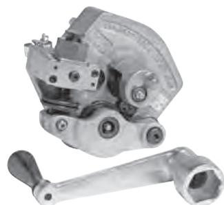
Scanalatrice per la scanalatura manuale di tubazioni in riparazione e applicazione su tubazioni esistenti in acciaio leggero, in acciaio Schedule 40, in acciaio inox, in PVC e in alluminio. Con il sistema brevettato di rotazione bidirezionale della macchina sul tubo si consente la scanalatura riducendo gli scarti. È disponibile un kit adattatore opzionale per alimentazione elettrica per l'esecuzione di scanalature.
