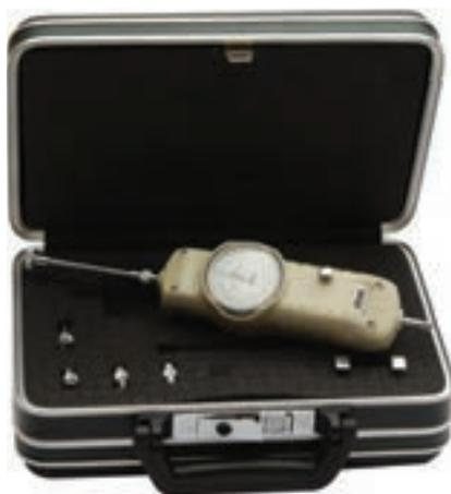
Serve per controllare la forza necessaria per sganciare i maniglioni antipanico e per verificare la forza di impatto in chiusura di una porta tagliafuoco nel rispetto delle norme tecniche vigenti.
