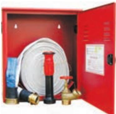
Completa di: rubinetto idrante DN 45 PN 16-ISO 7, tubazione Ø 45 mm certificata UNI EN 14540 raccordata UNI 804 con legatura a norma UNI 7422 con manicotti coprilegatura, sella salvamanichetta, simbolo di identificazione, istruzioni d'uso, istruzioni di montaggio, sigillo numerato, lancia a leva o a rotazione UNI 45, adesivo marcatura **CE**
