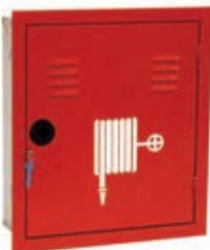
Completa di: rubinetto idrante DN 45 PN 16-ISO 7, tubazione Ø 45 mm certificata UNI EN 14540 raccordata UNI 804 con legatura a norma UNI 7422 con manicotti coprilegatura, sella salvamanichetta, simbolo di identificazione, istruzioni d'uso, istruzioni di montaggio, sigillo numerato, lancia a leva o a rotazione UNI 45, adesivo marcatura **CE**
