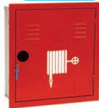
Costruite in acciaio zincato **VERNICIATURA:** a base di resine poliesteri speciali per esterni che ne garantiscono un'elevata resistenza alla corrosione, anche in ambienti marini (ISO 9227) - Le cassette vengono fornite complete di adesivo di identificazione, istruzioni d'uso ed istruzioni per l'installazione. I modelli "S" vengono forniti con sigillo di chiusura numerato, mentre i modelli "C" vengono forniti con due chiavi protette da lastra frangibile.
