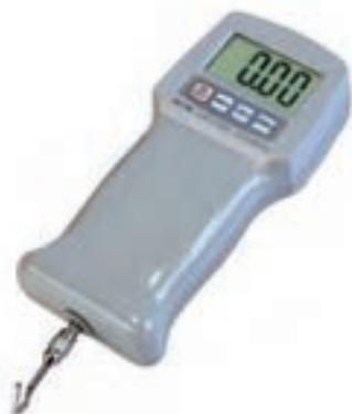
Dinamometro digitale per controllare la forza necessaria per sganciare i maniglioni antipanico e per verificare la forza di impatto in chiusura di una porta tagliafuoco nel rispetto delle norme tecniche vigenti. Precisione:  $\pm 0,5\%$  della potenza nominale. Dati frequenza di campionamento: 1000 Hz
