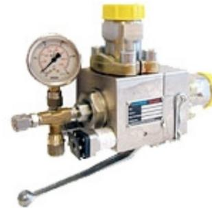
Le valvole di sezionamento si possono usare anche per bloccare manualmente la fornitura d'acqua, ad esempio in caso di operazioni di manutenzione di una data sezione. Per i test di manutenzione ordinari, le valvole di sezionamento sono dotate di appositi attacchi per simulare l'attivazione delle testine sprinkler.
